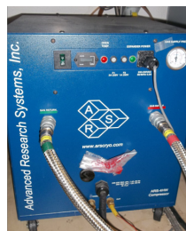
Figura 3.8: Compressor de gás hélio.
