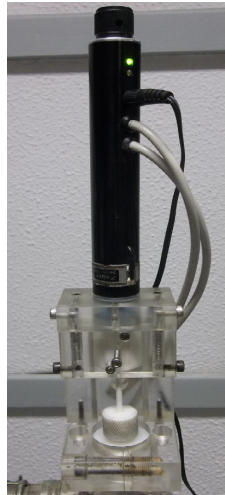
Figura 3.21: Sistema para movimentação e leitura da posição da amostra utilizando um posicionador Zaber modelo T_LA60A.
