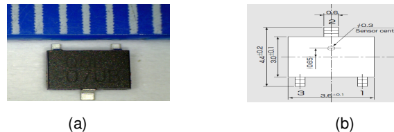
Figura 2.13: (a) Sensor Hall (Escala de 1 mm). (b) Eixo de sensibilidade do sensor [AKM User Manual, Model EQ-430L].
