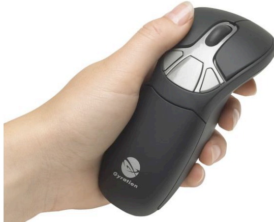
Figura 4.5: Mouse 3D com acelerômetro utilizado nos testes [Air Mouse 2011]
