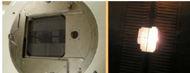
FIGURA 13 – Colimador de múltiplas folhas no lado esquerdo e campo irregular formado pelas lâminas no lado direito [19].
