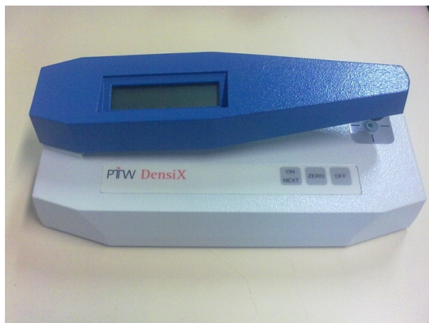
FIGURA 19 – Densitômetro Óptico PTW-DensiX tipo T52001 [53].
