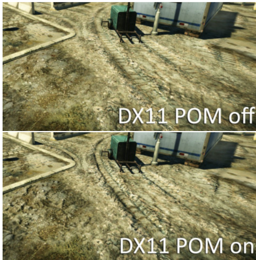
Figura 13: Renderização de cena com normal mapping e parallax occlusion mapping (imagem do jogo Crysis 2) (Crysis 2 DX11, 2011).
