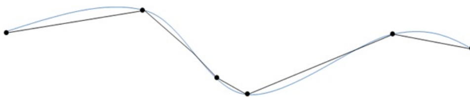
Figura 4.2: Grupo de pontos em preto representando o caminho do tubo. Em azul a linha central do tubo.
