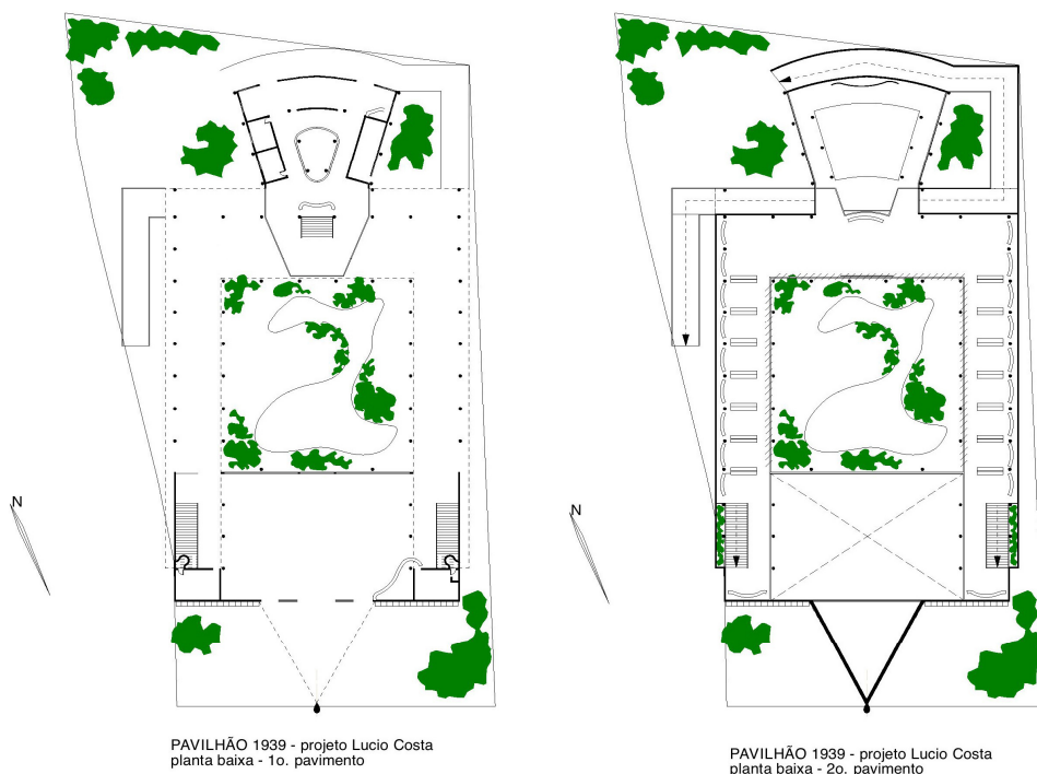
Figura33- Plantas baixas - projeto de Lucio Costa - 1o. prêmio no concurso para o pavilhão do Brasil na Exposição Internacional de 1939.
