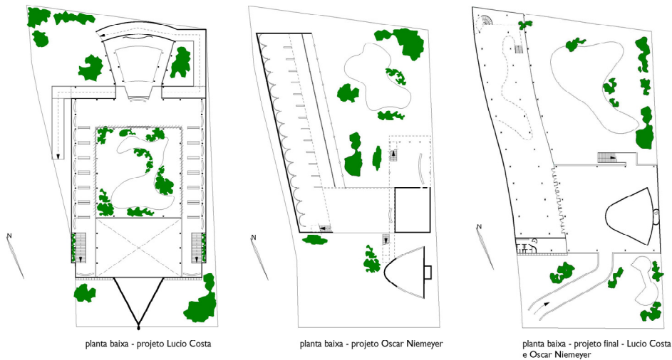
Figura54- Comparativo das plantas dos projetos do concurso e projeto final do pavilhão brasileiro de 1939, na feira de Nova Iorque.
