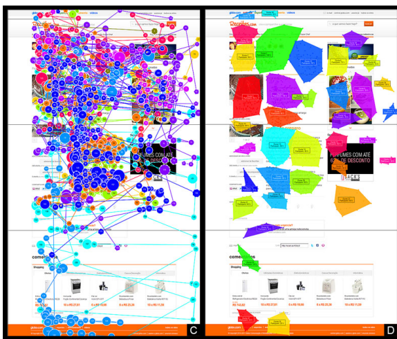
Figura 3.11. - A imagem apresenta a sobreposição dos dados das fixações dos dez usuários que acessaram essa página. A letra 'C' exibe o mapa de percurso do olhar e a letra 'D' o mapa com os clusters .
