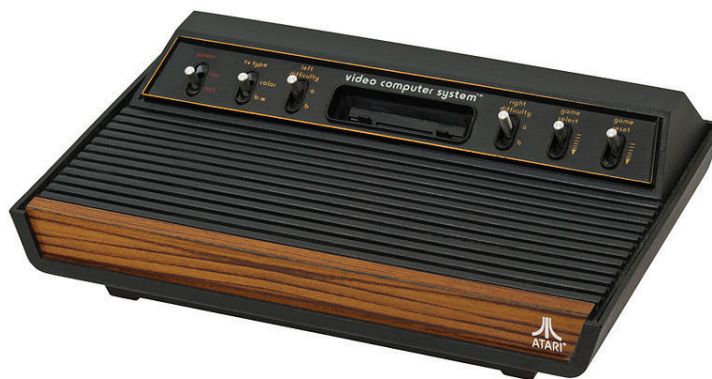
Figura 1.1: Switches do Atari 2600. Da esquerda para a direita: power , cor, dificuldade do jogador à esquerda, dificuldade do jogador à direita, seletor de jogo, reset . Fonte: Wikipedia, licenciada sob Creative Commons Attribution-Share Alike 3.0
