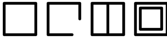
Figura 2.5: Exemplo de modelos. O modelo mais à esquerda é considerado watertight , os outros não se encaixam na definição.
