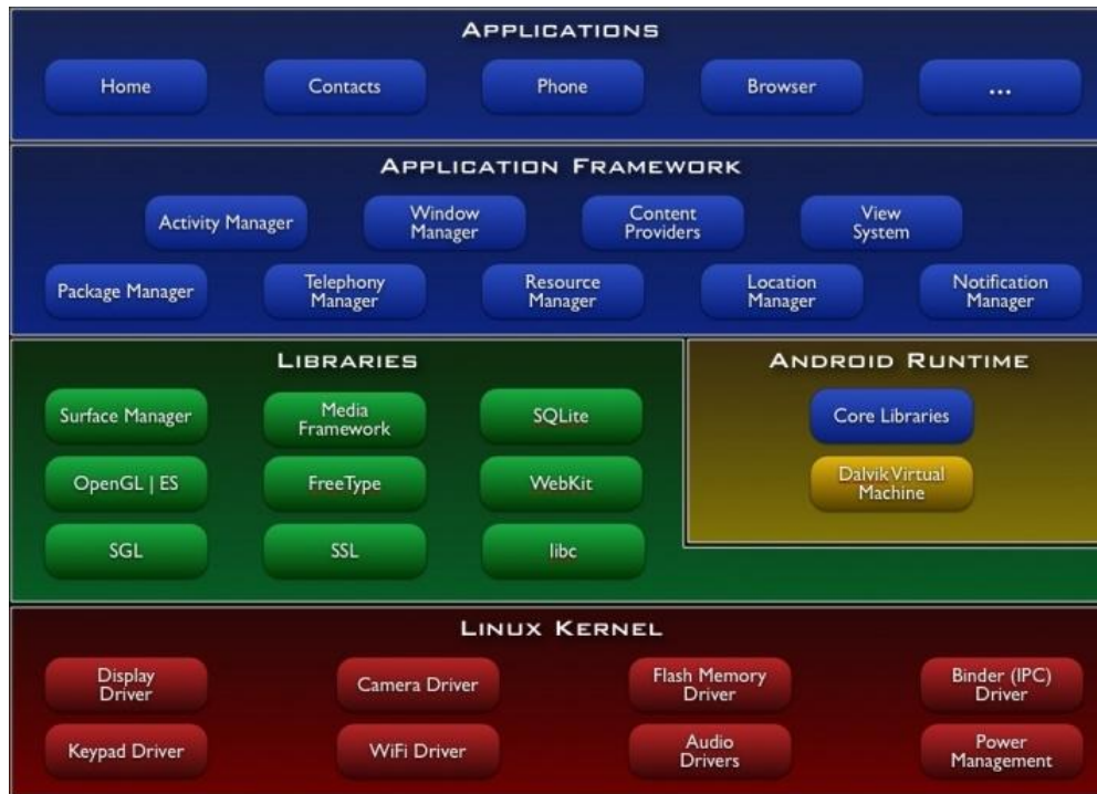
Figura 3.2 – Arquitetura do sistema operacional Android (GOOGLE, 2010b).
