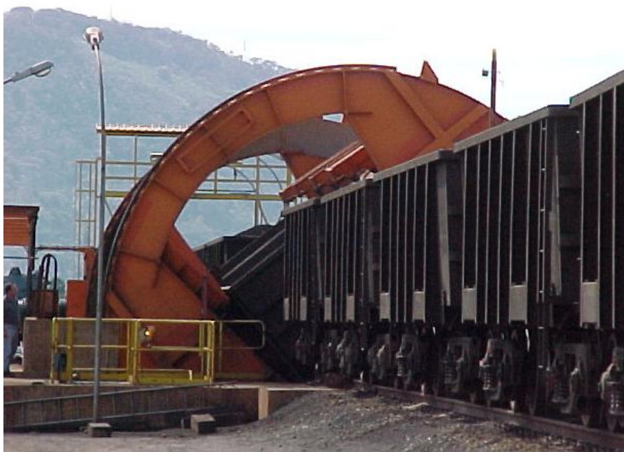
Figura 22 – Virador de vagões no terminal de descarga. Fonte: MRS
