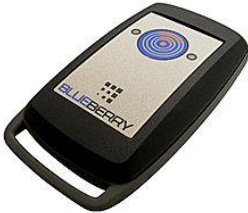
Figura 6: leitor/escritor RFID 860 - 960 MHz, 10 - 20 cm | BlueBerry UHF capaz de ler/graver um tag UHF RFID e transmitir via Bluetooth para qualquer equipamento que contenha a interface.
