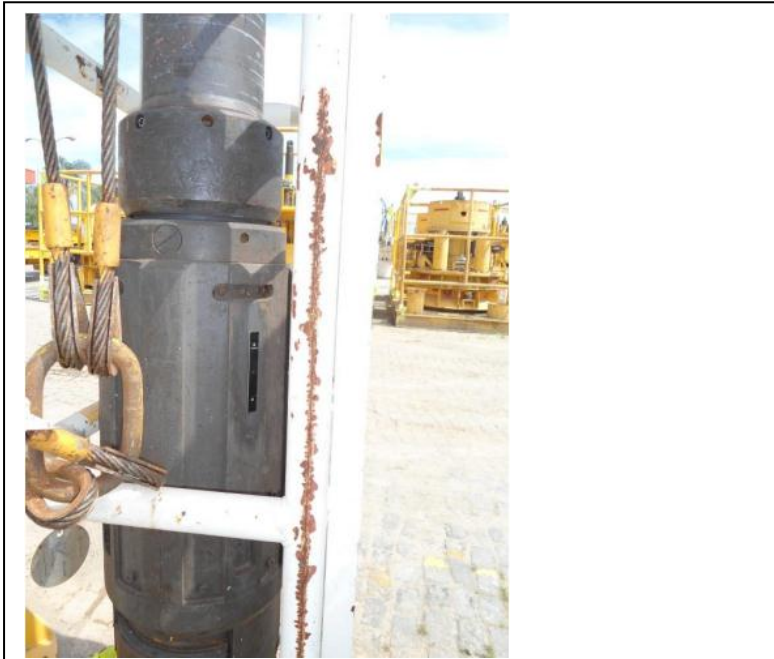
Figura -11: Mostra dispositivos Transponders RFID instalados com dinâmica de comunicação aproximada de 2 metros utilizando-se Coletor de Dados Motorola modelo MC9090G. Fonte: I-Dutto
