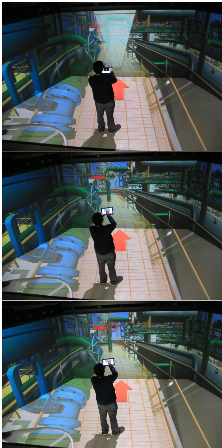
Figura 5.4: Etapas de seleção/manipulação de uma válvula no SimUEP-AmbSim: na primeira figura, o usuário posiciona a câmera virtual de forma a conter a válvula; na segunda figura, ele seleciona o objeto já desenhado na interface do tablet ; na terceira, ele confirma a seleção e rotaciona a válvula.
