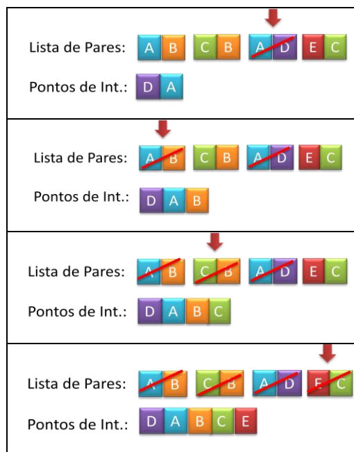
Figura 13: Algoritmo de Tempo Quadrático para Ordenação de Pares de Pontos de Interseção Triângulo-Triângulo (a) e seu Passo-a-Passo (b).
