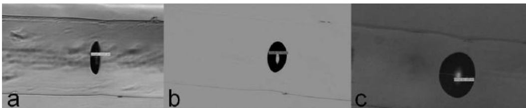
Figura 19 - Imagens de microscópio óptico de três fibras com cavidades de ar usadas como sensor de deformação [3].
