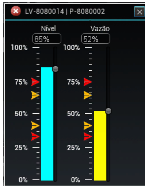
Figura 24. Faceplate da válvula LV-80800014 que controla o permutador P-8080002.
