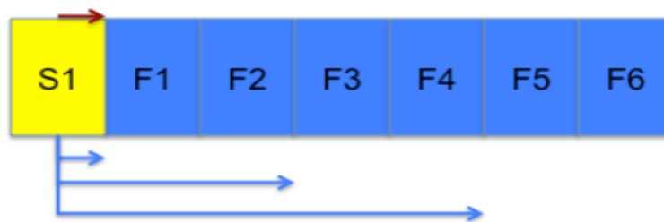
Figura A.4 - Exemplo simples de um segmento (o bloco amarelo representa o índice do segmento S1; Os blocos azuis são os fragmentos movie que contêm os dados; A seta vermelha acima de S1 representa a sequência dos fragmentos no primeiro loop; As setas azuis mostram os ponteiros do índice no segundo loop) (Stockhammer 2011).
