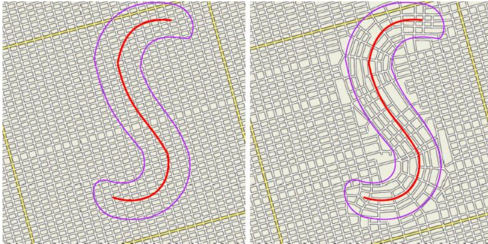
Figura 2.19 Alterações feitas ao campo tensor refletem diretamente na malha rodoviária gerada a partir dele [4]
