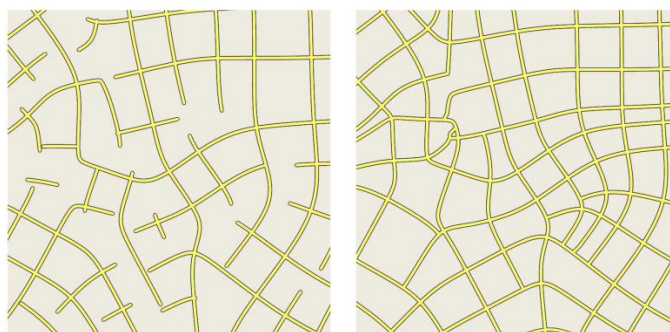
Figura 2.21 Malha rodoviária gerada sem (esquerda) e com (direita) aderência de vias próximas [4]
