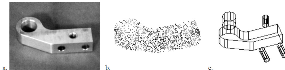
Figura 3.1: Engenharia reversa de uma peça industrial. (a) Objeto do mundo real, (b) Nuvem de pontos 3D do objeto, (c) Elementos geométricos recuperados através da engenharia reversa (Thompson et al. , 1999).
