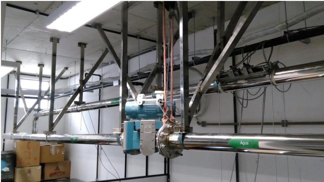
Figura 36: Testes com medidor instalado à montante com 41 DN de trechos retos.
