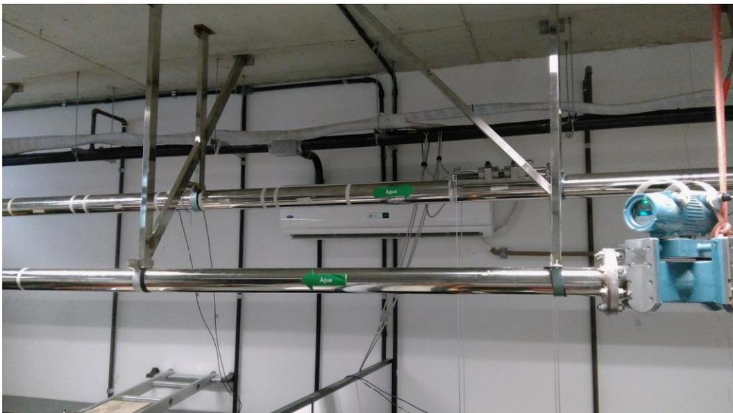
Figura 34: Testes com medidor instalado à montante com 29 DN de trechos retos.
