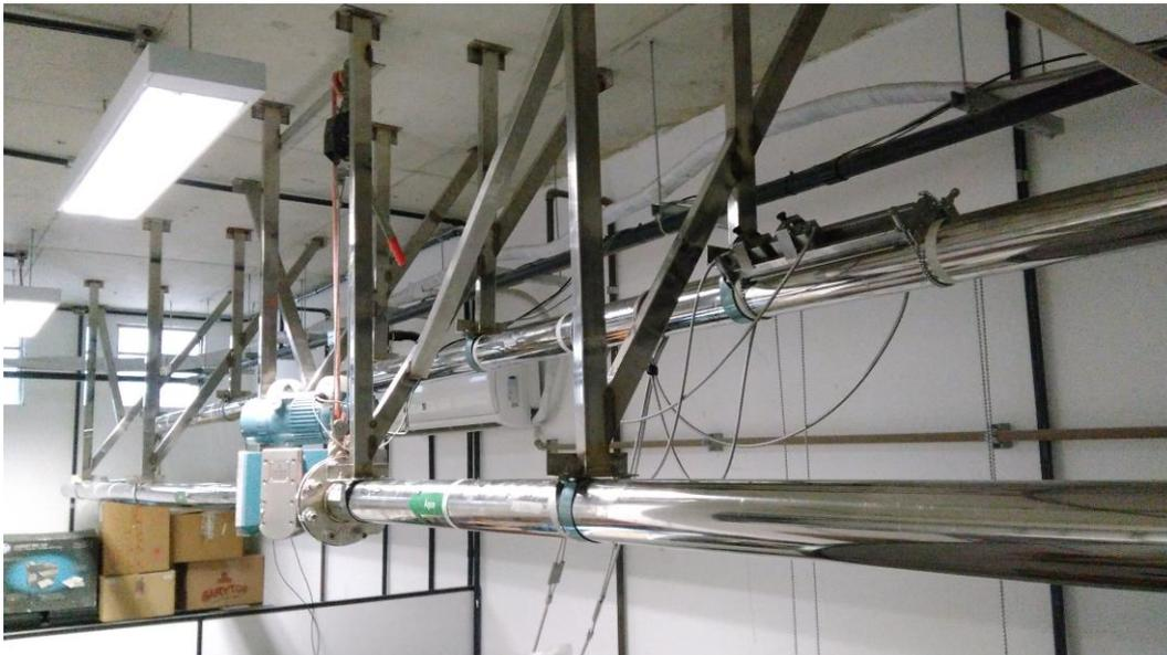
Figura 38: Testes com medidor instalado à montante com 50 DN de trechos retos.
