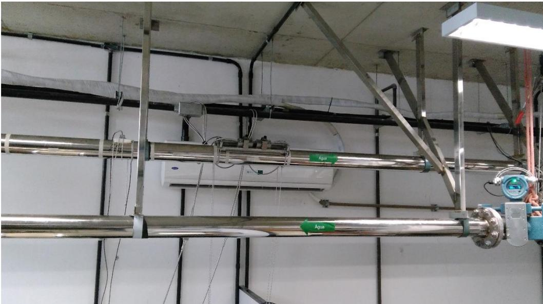
Figura 32: Testes com medidor instalado à montante com 20 DN de trechos retos.
