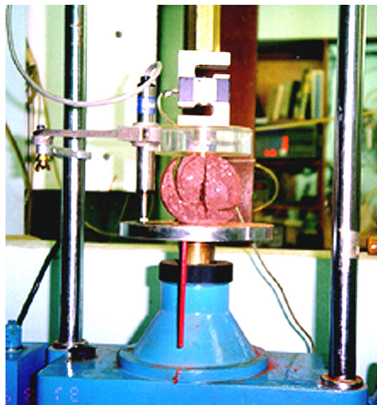
FIGURA 4.52: Registro do Ensaio de Compressão Diametral – Formação de Novas Trincas Devido a Fissuras Pré Existentes.
