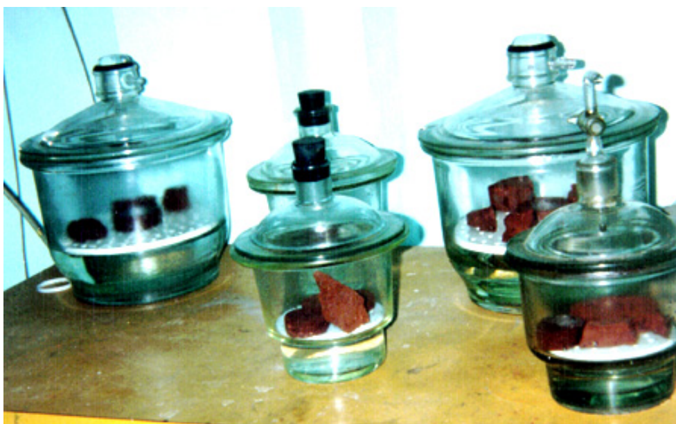
FIGURA 5.28: Vista dos Dessecadores Usados para Medição de Sucção Total.
