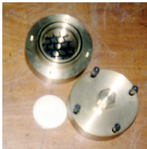
FIGURA 5.13: Detalhe da Câmara de Equalização Utilizada nos Ensaio de Papel Filtro Semi – Montada.
