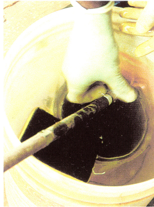
FIGURA 7.15: Seqüência de Montagem Da Ponta Cônica da Sonda Piezométrica
