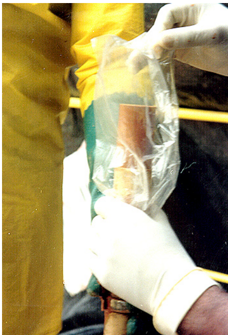
FIGURA 9.20: Uso do Amostrador Para Lamas de Alta Densidade
