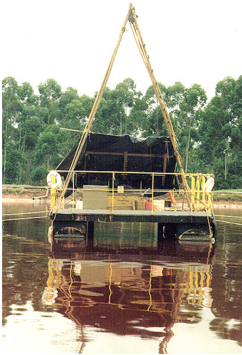
FIGURA 7.9: Balsa Usada em Reservatórios Navegáveis e Resíduos Espessados
