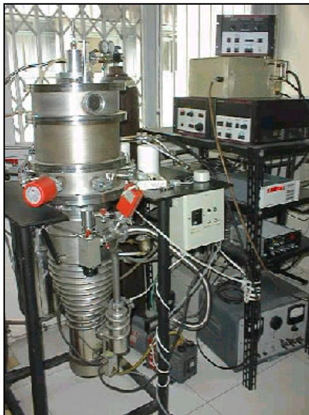
Figura 3.1 - Sistema de deposição do Laboratório de Revestimentos Protetores da PUC-Rio.
