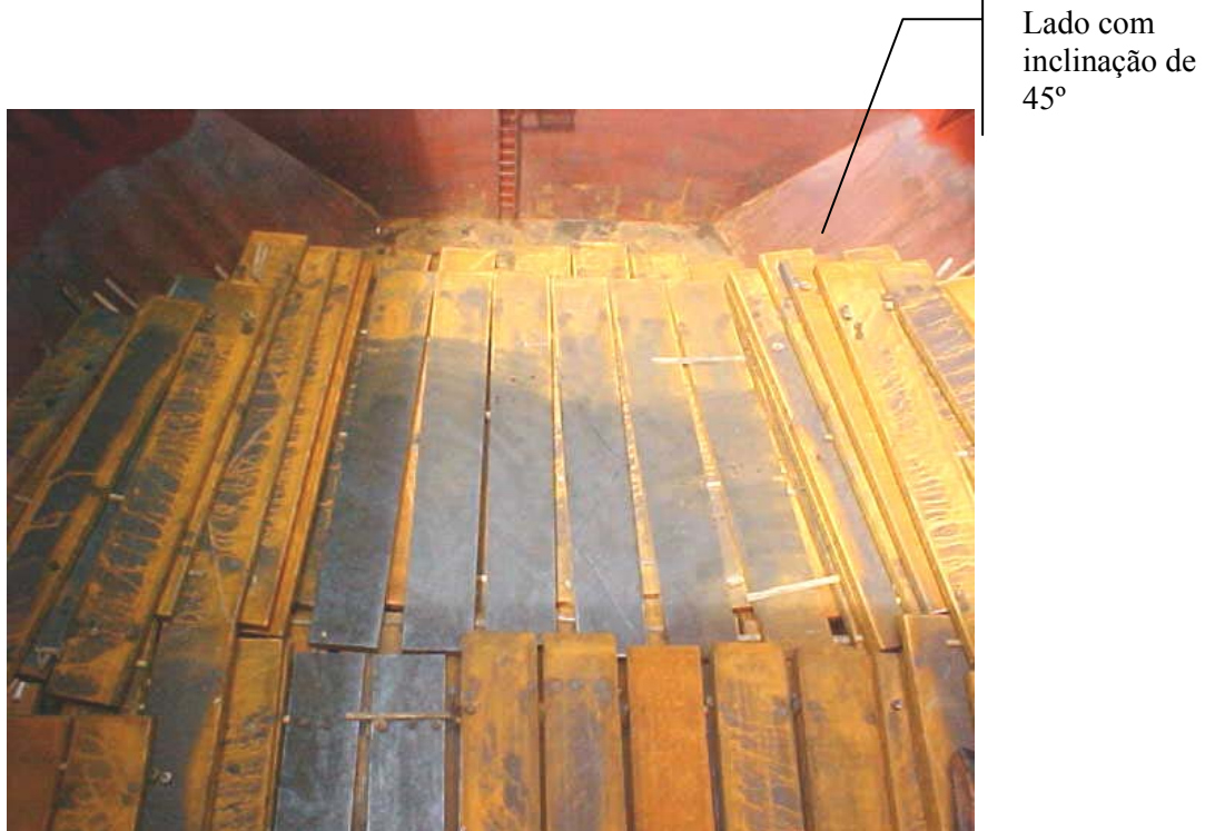
Figura 31 – Inclinação de 45^\circ no lado do porão no sentido popa-proa
