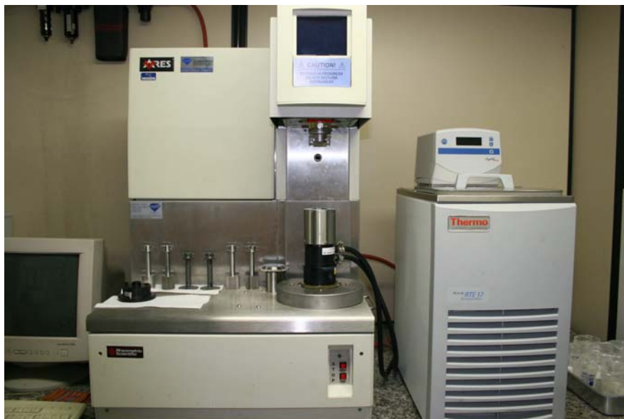
Figura 2.12: Reômetro Rotacional Ares utilizado na caracterização reológica das emulsões.
