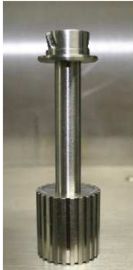
Figura 2.13: Geometria do tipo Couette com rugosidade, usada com o reômetro rotacional Ares para as medições reológicas.
