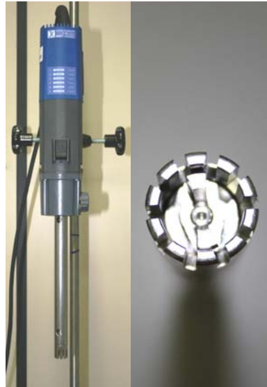
Figura 2.5: Aparato dispersor Ultraturrax T-25 usado para a preparação das emulsões.
