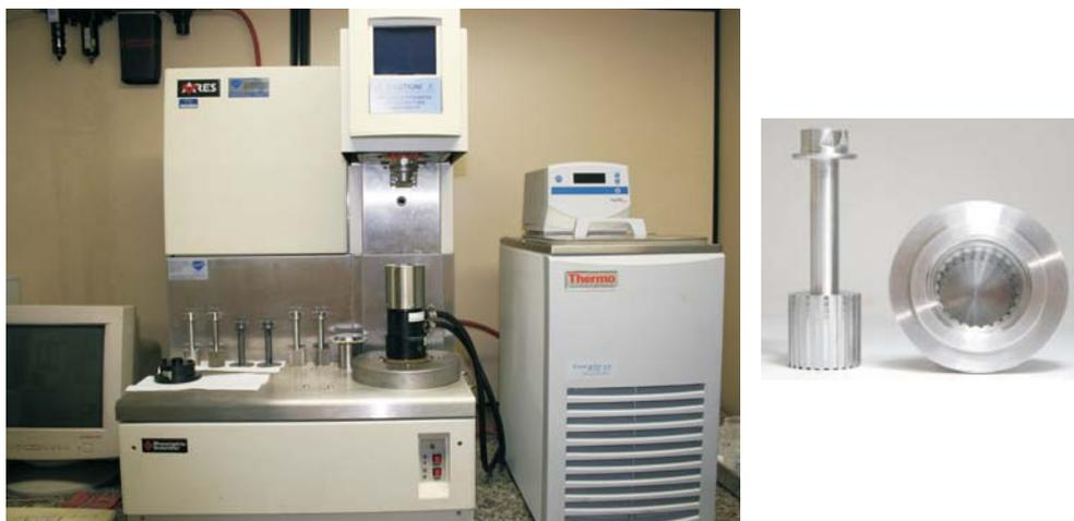
Figura 3.6: Reometro Ares, e a geometria “ Grooved”.
