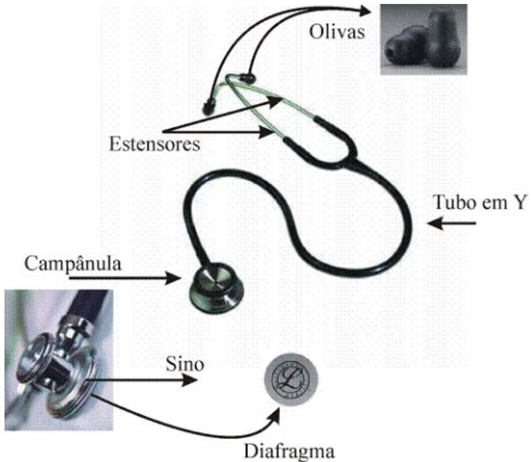
Figura 16 - Estetoscópio mecânico e seus componentes. Fonte: (figura montada com base em fotos obtidas no site www.3m.com/br/hospitalar )
