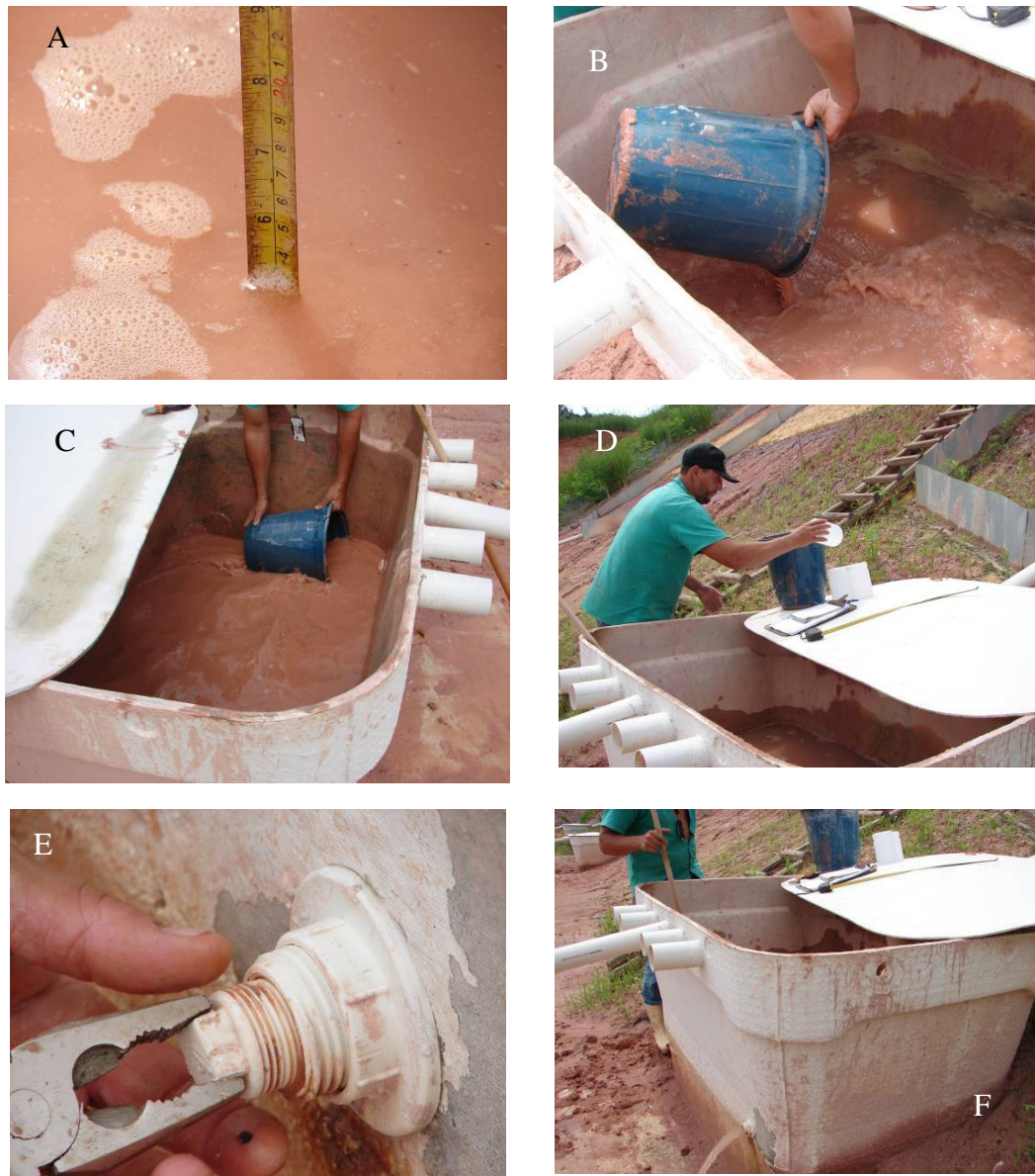
Figura 2-72 A – medição do nível na caixa coletora. B, C – homogeneização do material. D - Coleta de amostras de escoamento superficial. E – abertura do flange com alicate. F – esvaziamento da caixa após a execução das medições.
