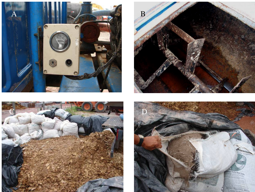
Figura 2-78 A – termômetro para monitoramento da temperatura dentro do tanque. B – sistema de agitação da massa. C – Celulose utilizada como Mulch. E – esterco de curral aplicado após o jateamento para fixação e adubação final.
