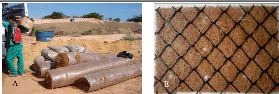
Figura 2-85 A - Aspecto das biomantas embaladas para transporte e fornecimento. B – aspecto da biomanta em detalhe, observando-se a tela georreforçadora e a matriz orgânica de fibra de coco.
