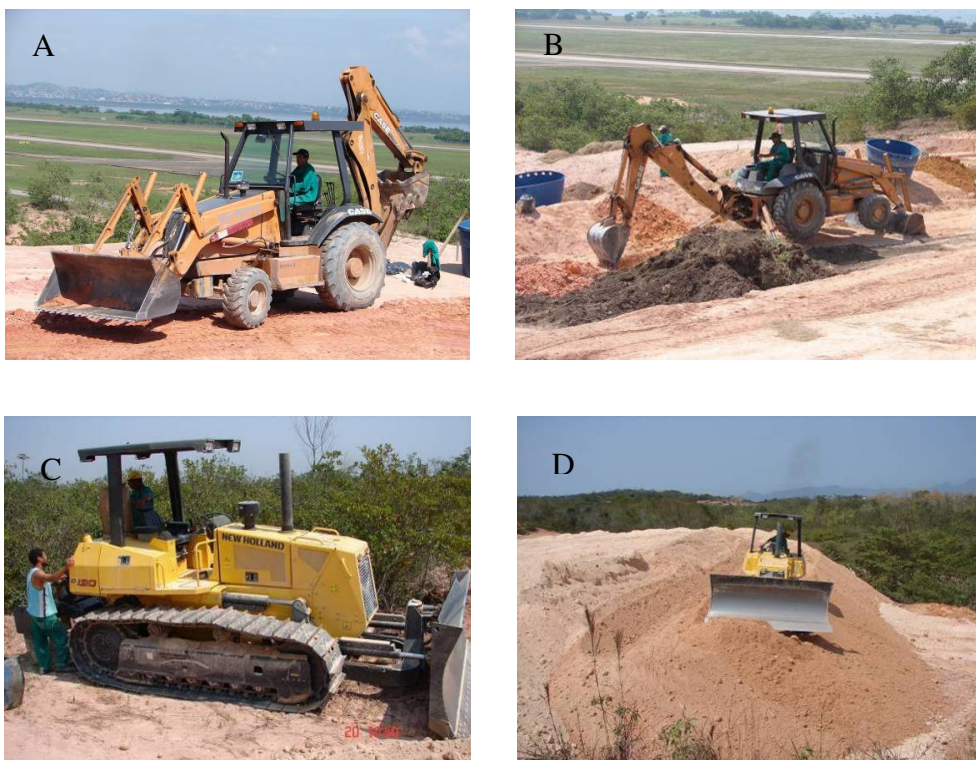
Figura 2-50 Implementos utilizados nos processos de RAD na área Z. A, B, C, D, E – Case 580L. F,G,H – New Holland D130.
