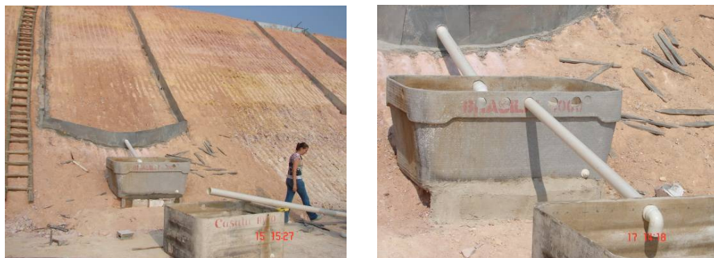
Figura 2-66 Posicionamento dos canos. Os comprimentos e gradiente foram mantidos para todas as parcelas.
