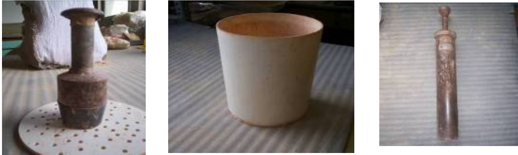
Figura 4-19 Material utilizado para e extração de amostras indeformadas (Kopecky) e para montagem dos corpos de prova. Da esquerda para a direita: amostrador Kopecky, cilindro para realização do ensaio, cilindro compactador Proctor Normal.
