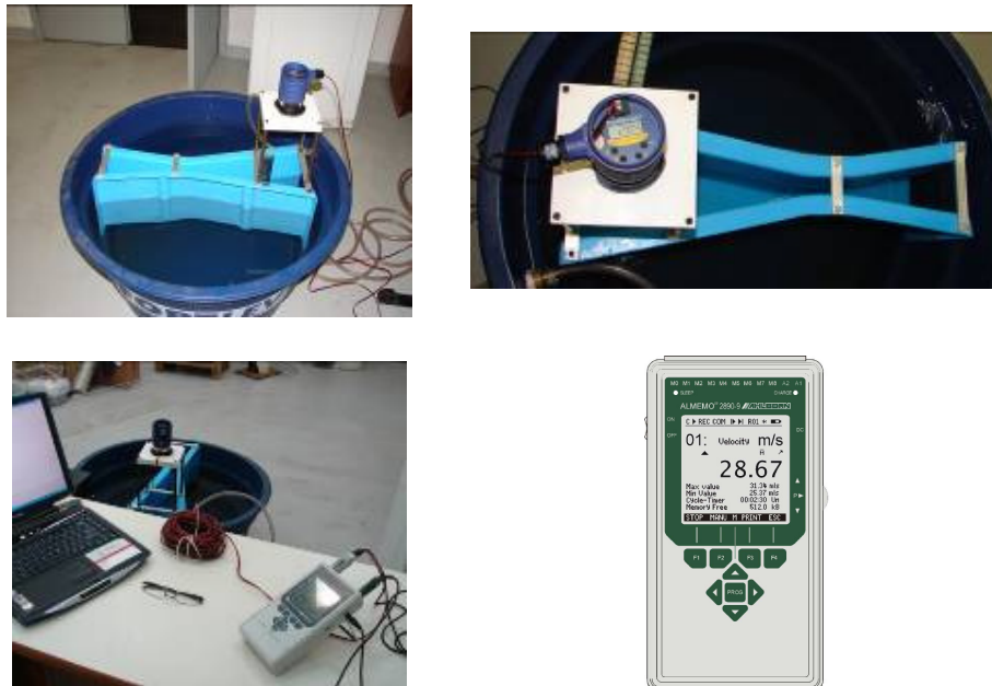
Figura 4-46 Transmissores LU-20 5001 acoplados às Calhas CPARSHALL, conectados ao logger ALMEMO ® 2890-9 e ao PC. A caixa d'água é usada para calibrar o transmissor para diferentes níveis da Calha Parshall.
