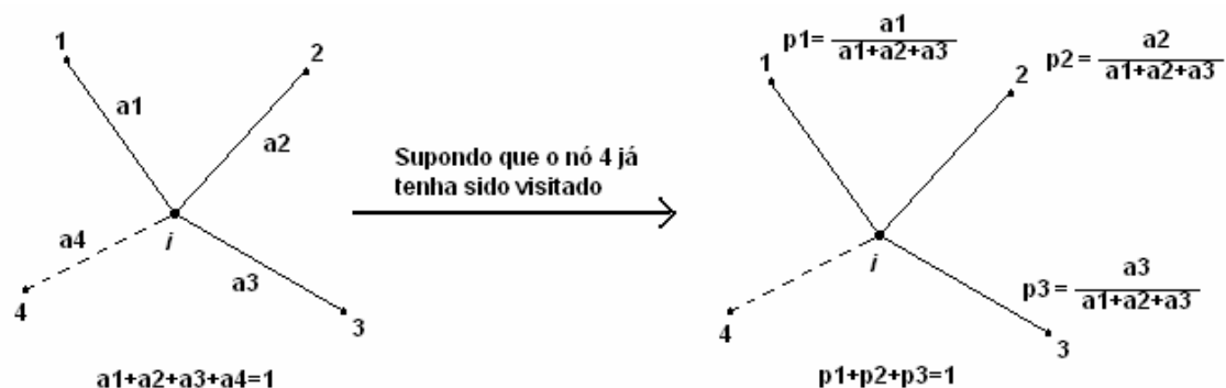
Figura 3 – Cálculo das probabilidades de escolha de um arco, para o Ant System
