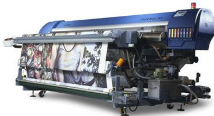
Figura 107.: Máquina de estampar digital marca STORK, modelo Tourmaline.
