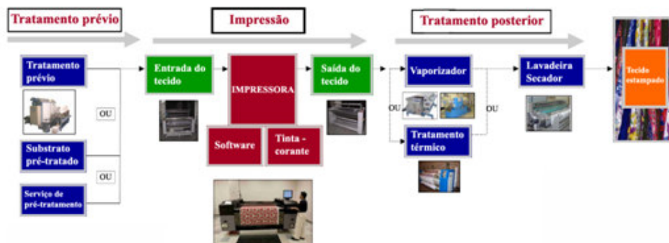
Figura 108.: Fluxo do processo de impressão digital
