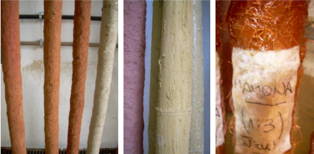
Figura 61 – Peças de bambu com diversos revestimentos naturais
