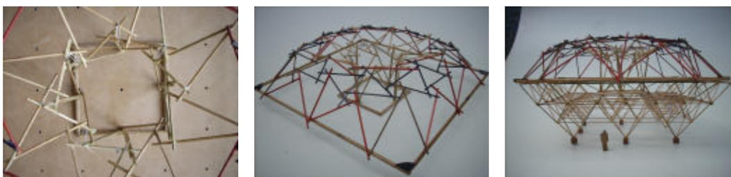
Figura 108 – Detalhe da estrutura central e imagens do modelo 14
