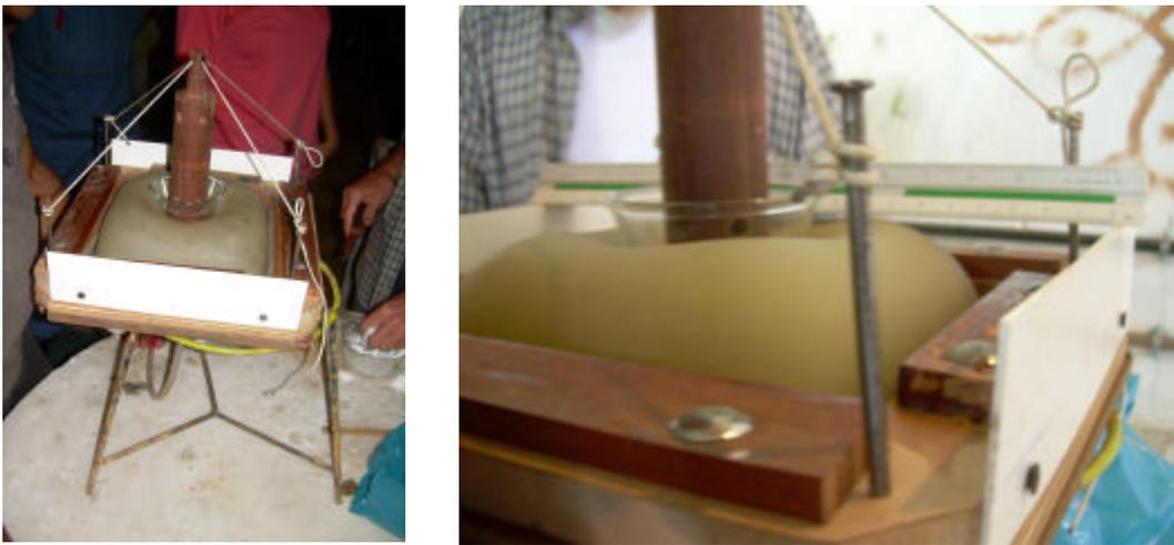
Figura 87 – Dispositivo para experimentos controlados com membrana de látex
