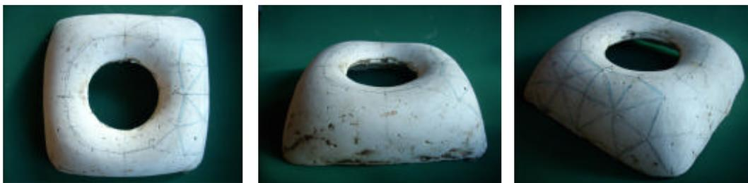
Figura 89 – Modelo em gesso feito em fresa a partir de modelo virtual
