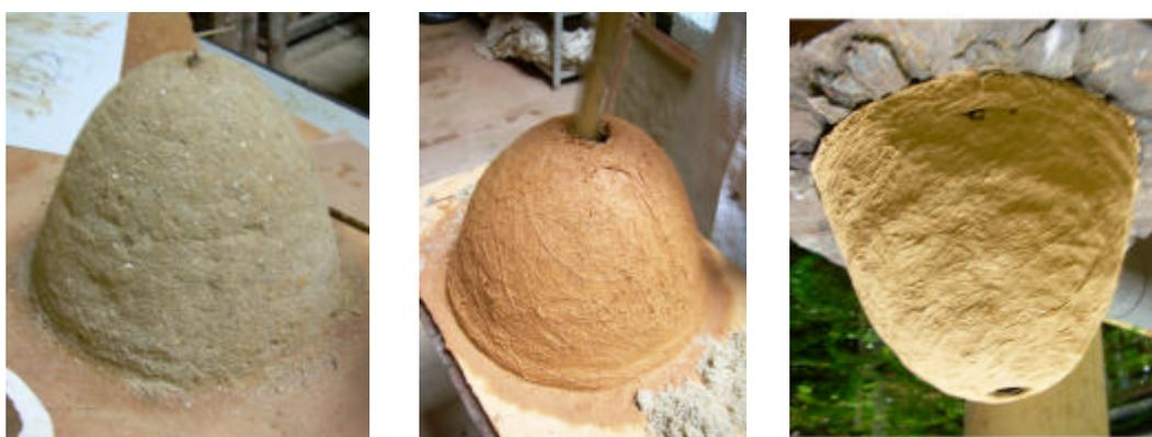
Figura 52 – Modelo da cúpula catenária: Forma de areia. Fibro-barro. Desmoldado.
