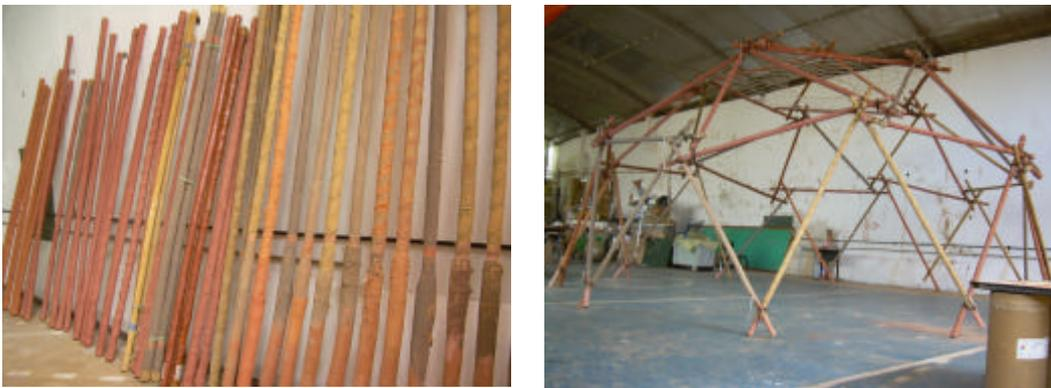
Figura 62 – Peças prontas para montagem e domo geodésico montado no LILD
