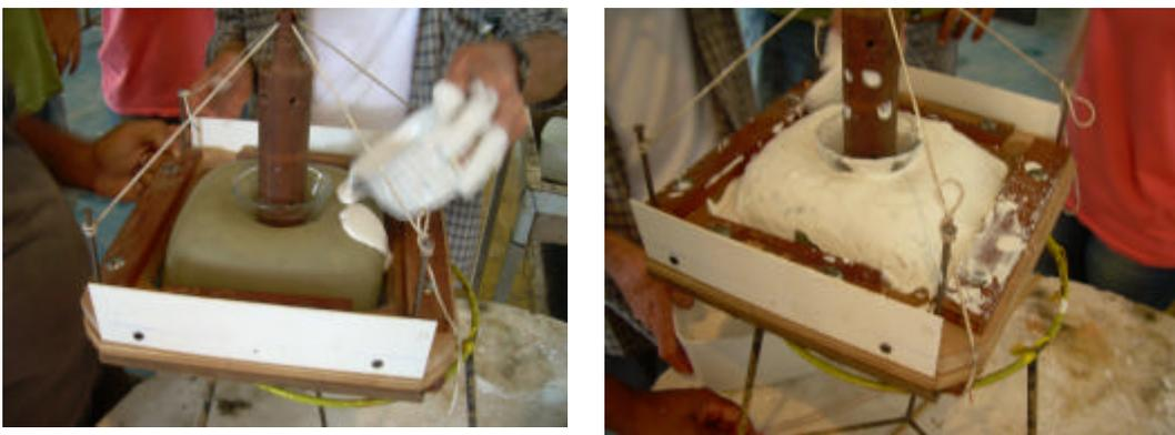
Figura 88 – Tentativa de extrair uma fôrma de gesso a partir do látex inflado
