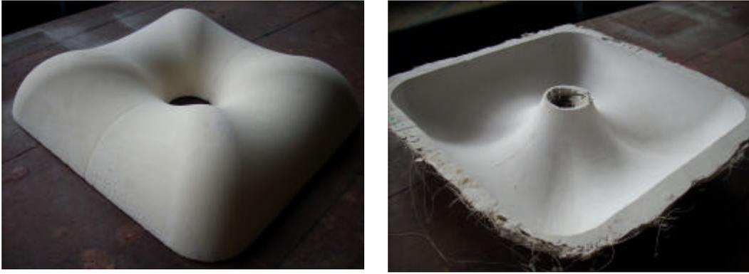
Figura 122 – Forma feita em fresa CNC e molde negativo de gesso
