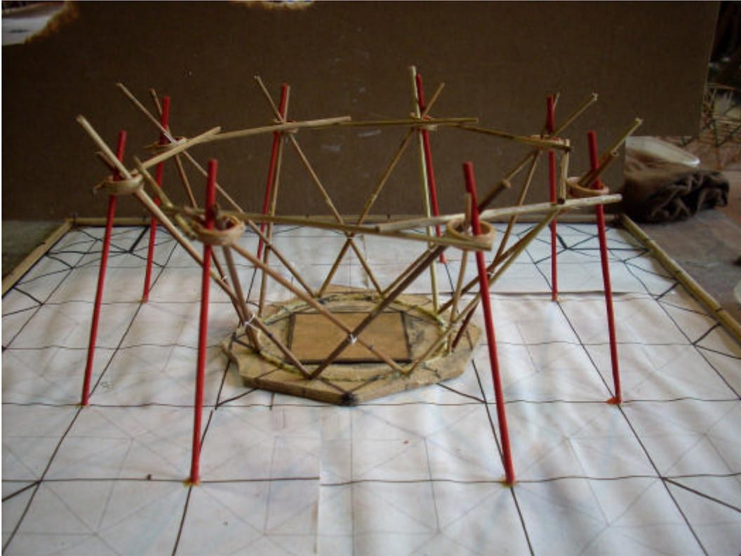
Figura 128 – Estrutura central montada com o auxílio dos tripés
