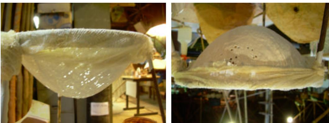
Figura 55 – Experimento com deformação: o que funciona à tração quando invertido funciona à compressão
