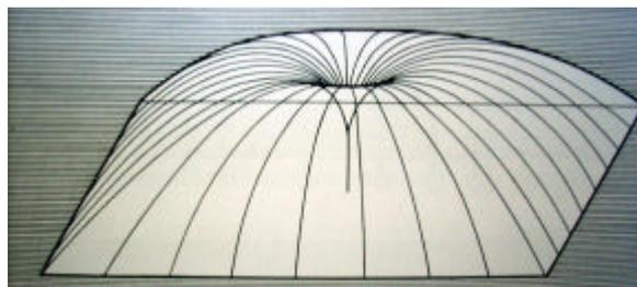
Figura 77 – Figura do Engel ilustrando as forças atuantes com ponto de ancoragem interno e perspectiva da forma
