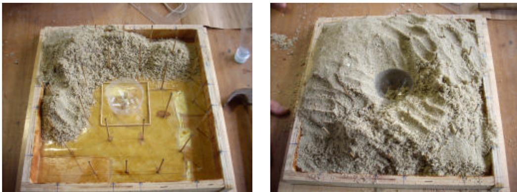
Figura 115 – Dispositivo verificador de superfície sendo preenchido de areia
