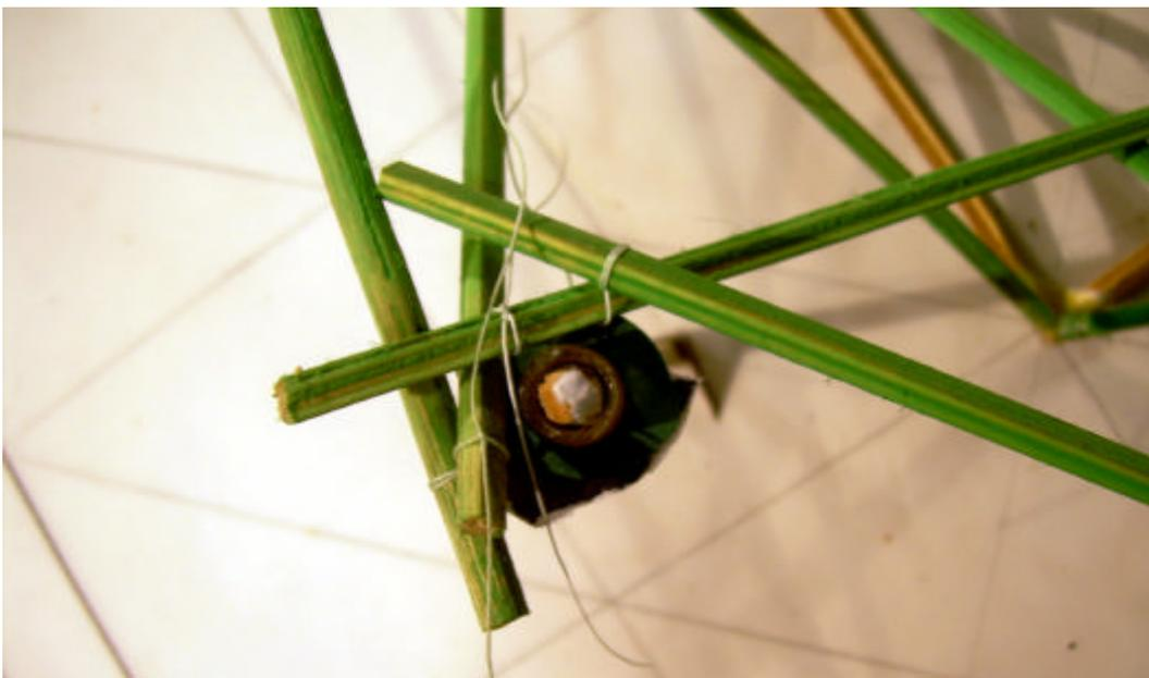
Figura 102 – Detalhe do giro sobre o suporte com as barras amarradas
