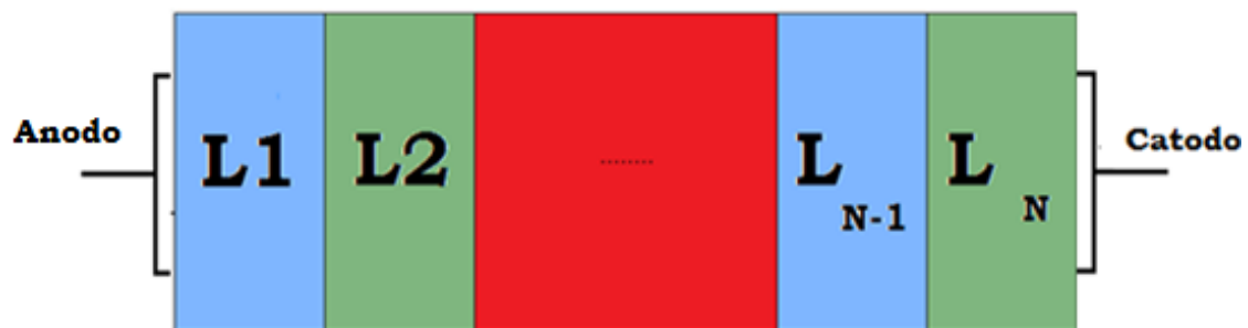
Figura 2.8: Estrutura geral de um ML-OLED.
