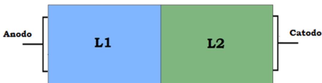
Figura 2.6: Estrutura de um OLED bicamada.
