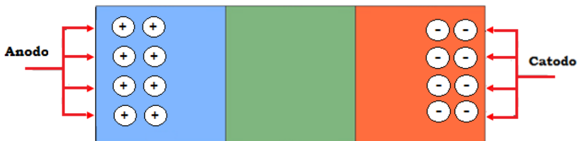
Figura 2.10: Injeção de buracos e elétrons.
