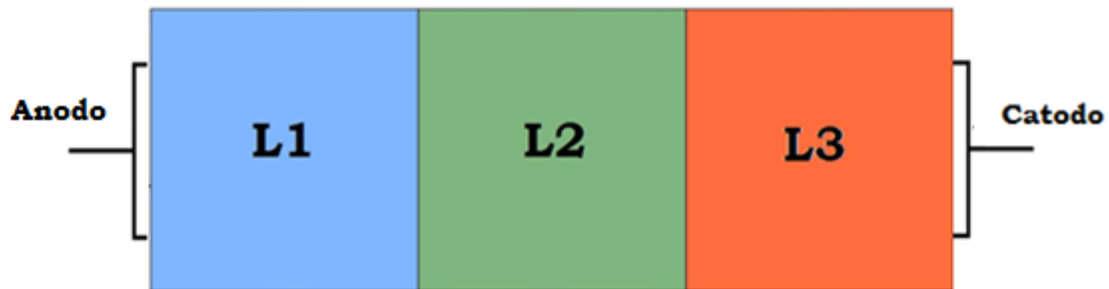
Figura. 2.7: Estrutura de um OLED tricamada.
