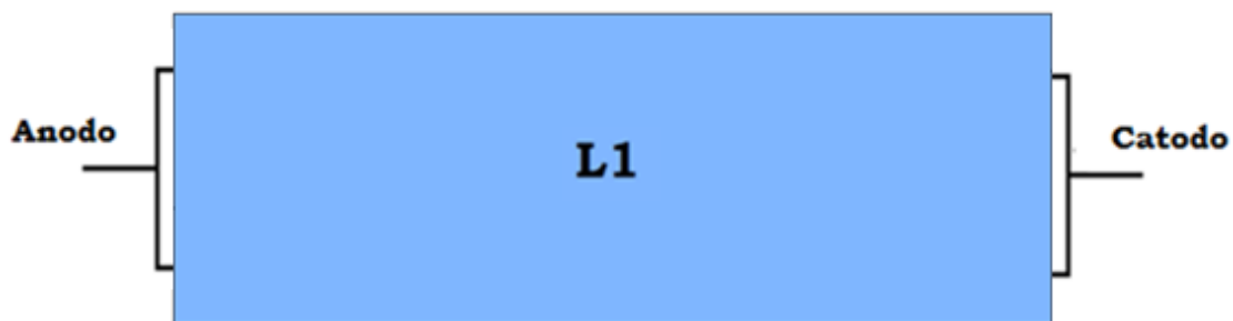
Figura 2.5: Estrutura de um OLED monocamada.
