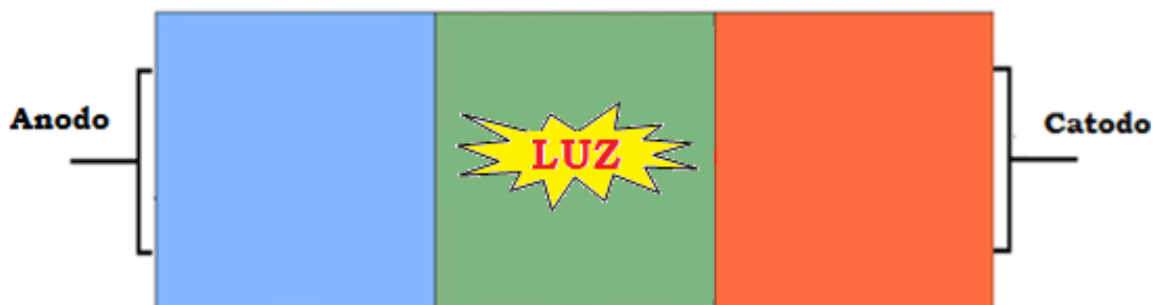
Figura 2.13: Recombinação de portadores de carga e emissão de luz.
