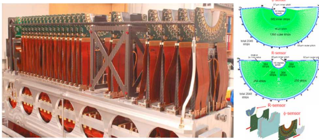
Figura 4.6: A imagem à esquerda representa a disposição dos módulos do VELO no LHCb. A direita estão os sensores R e \phi , e sua composição no módulo.
