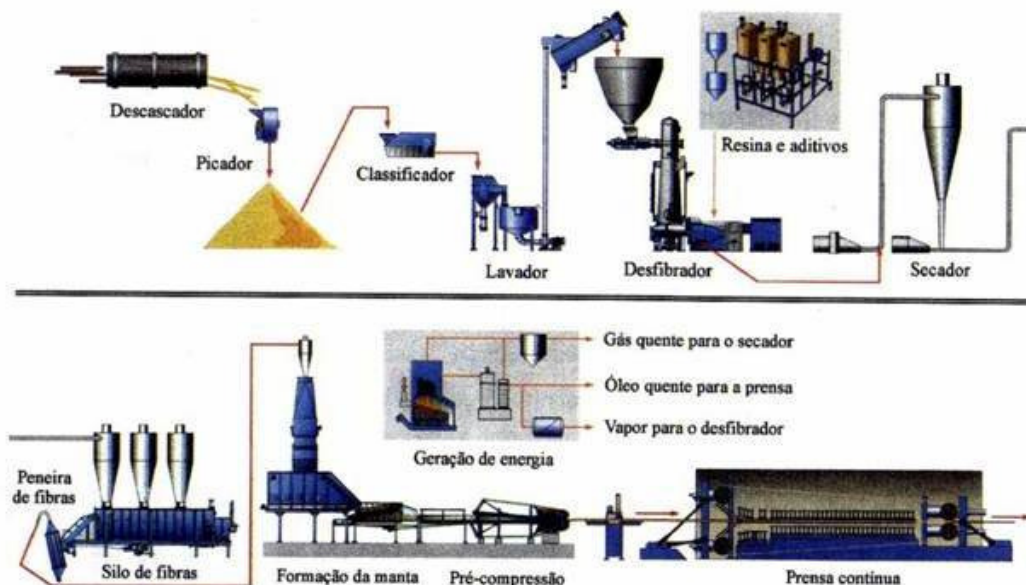
Figura 13 – Processo Produtivo Chapas de Madeira
