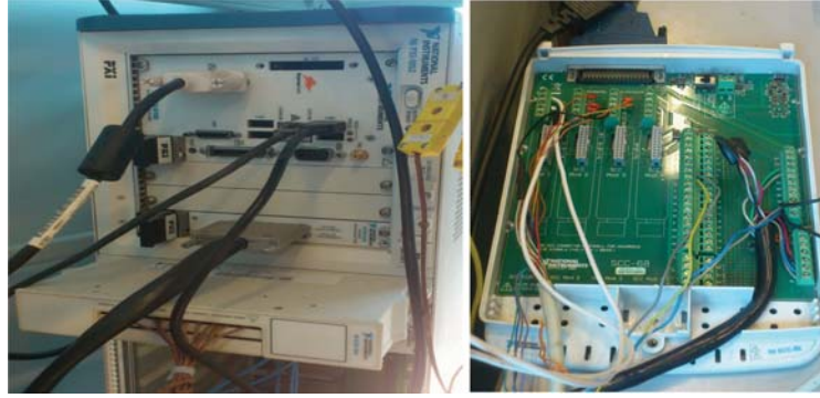
Figura 4.2: Sistema PXI com módulos auxiliares e placa de aquisição de dados DAQ.
