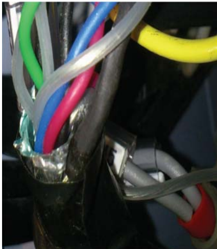
Figura 3.28: Detalhe do cabo do encoder com dupla blindagem.
