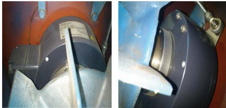
Figura 3.9: Encoder instalado no eixo do dinamômetro.
