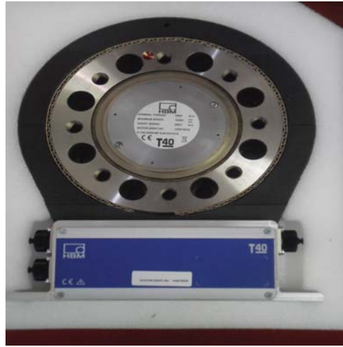
Figura 3.4: Transdutor de torque do tipo flange.
