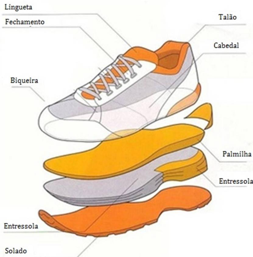
Figura 49 - Estrutura, em número de partes, de modelo similar ao proposto pelo projeto da norma específica ao calçado escolar do Brasil (A partir de Tênis para corrida, 2015).
