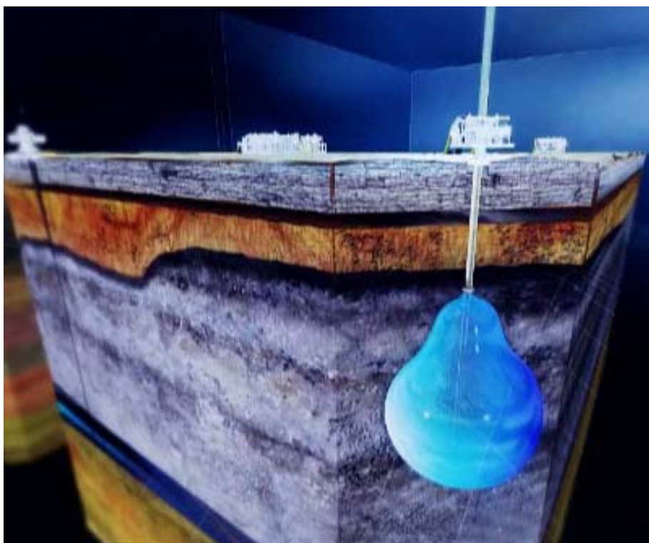
Figura 19 - Desenvolvimento da caverna pelo uso de bombeio submerso sem uso contínuo de sonda de apoio. Fonte: Costa et al. (2008).
