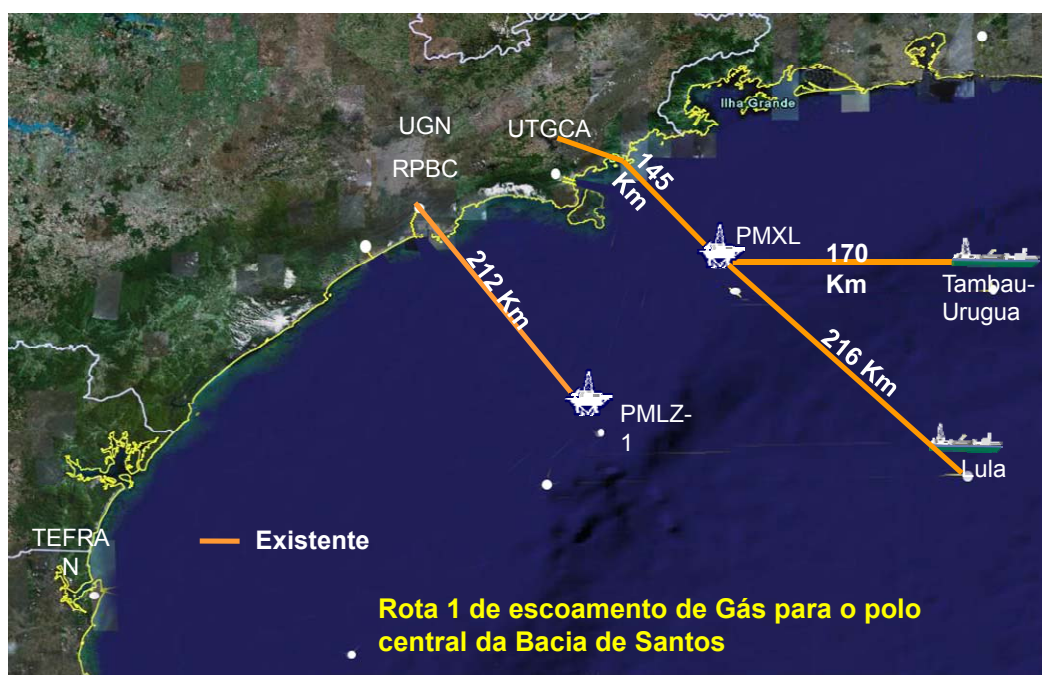
Figura 32 - Logística de escoamento de gás natural da Bacia de Santos (Rota 1). Fonte: Costa (2011).
