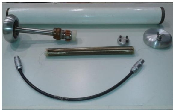
Figura 22 – Detalhes da estrutura de um divisor resistivo para medição de impulso atmosférico e seus componentes.
