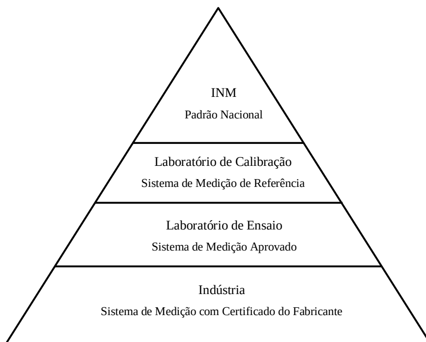
Figura 18 – Hierarquia de um equipamento de medição utilizado para ensaios de alta tensão, que são rastreados aos padrões de medição mantidos no Instituto Nacional de Metrologia (INM).
