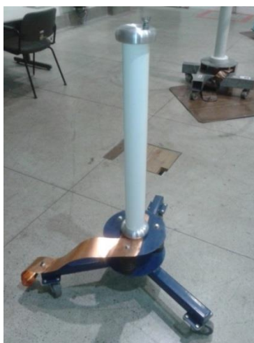
Figura 23 – Divisor resistivo para medição de impulso atmosférico.
