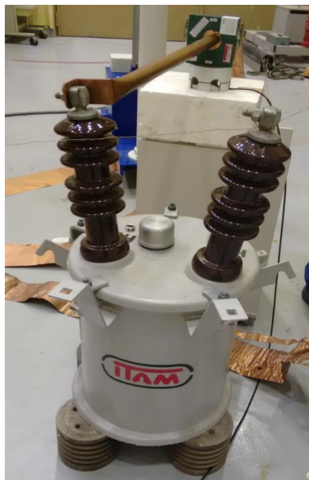
Figura 40 – Transformador de distribuição.
