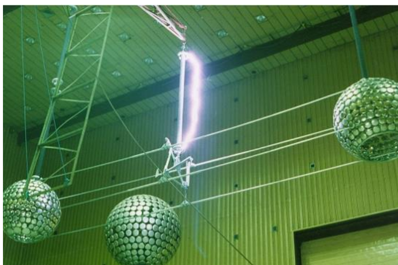
Figura 1 - Impulso atmosférico em cadeia de isoladores poliméricos.
